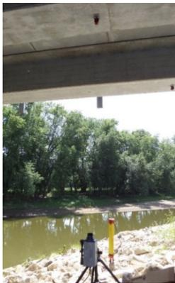
Figure 5. Remote sensing vibrometer (RSV-150).
