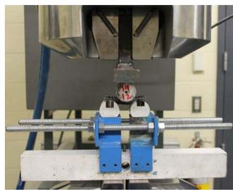
a) Interlaminar shear test
