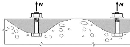
Figure 4: Breakout Failure (Rolf et al, 2006)
