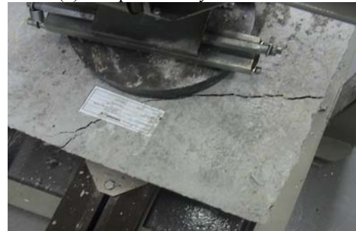
(d) typical slab failure (top view)
