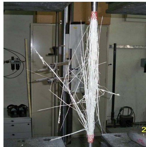
(d) initiation of the brooming of the specimen
